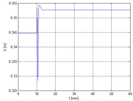
(d) Fluid II: Time evolution of measured depth, 37<sup>th</sup> cell.
